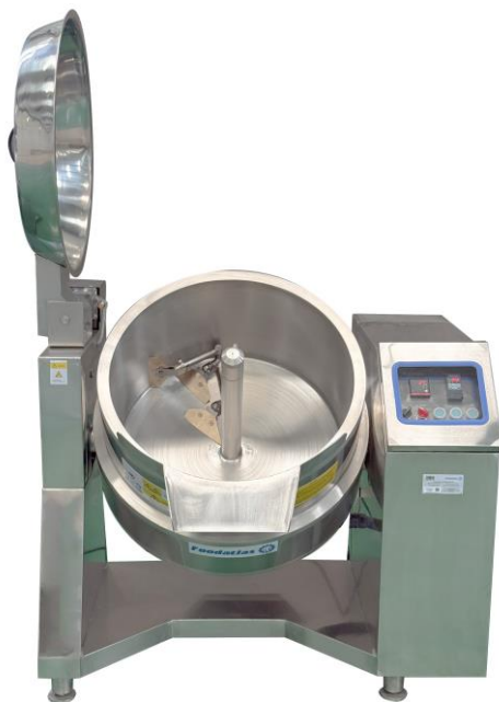
Рис.№2 Модель – XDC-60. Внешний вид модели и тип месильного органа
