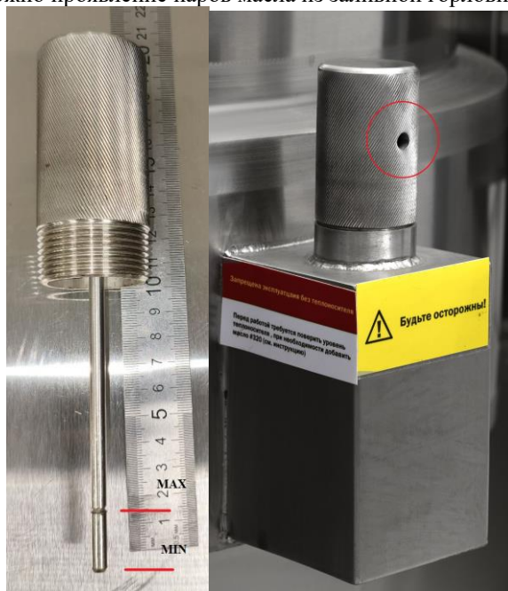
Рис№3 Отметка уровня теплоносителя на щупе. Вентиляционное отверстие масляной рубашки
